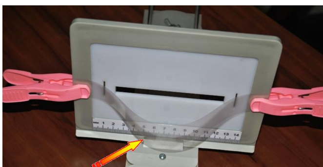
Obr. 1B Experimentální složení pro studium dvojlomu v pravítku. Šipka označuje bílý papír zakrývající polarizátor 1.
