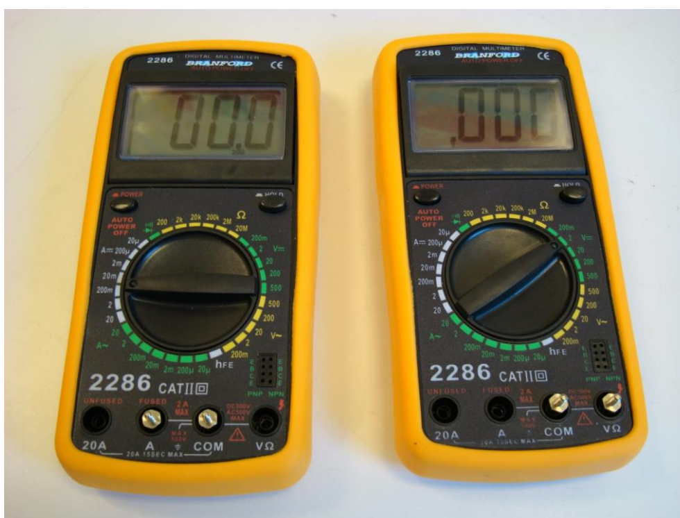
Obrázek 2.3 Multimetry opatřené vývody k použití jako ampérmetr ( vlevo ), resp. voltmetr ( right ). Přístroj se zapíná stisknutím tlačítka „POWER“ v levém horním rohu. Přístroj se sám automaticky vypne po jisté době nečinnosti. Lze s ním měřit stejnosměrný proud a napětí (=), jakožto i střídavý proud a napětí (~). Vnitřní odpor voltmetru je 10 MΩ bez ohledu na měřicí rozsah. Napětí na ampérmetru je 200 mV při maximálním proudu v daném rozsahu, nezávisle na měřicím rozsahu. Pokud dojde k přetečení rozsahu, na displeji se objeví „1“ a musíte zvolit vyšší měřicí rozsah. Nedotýkejte se tlačítka „HOLD“ v pravém horním rohu, ledaže byste chtěli zmrazit měření.
