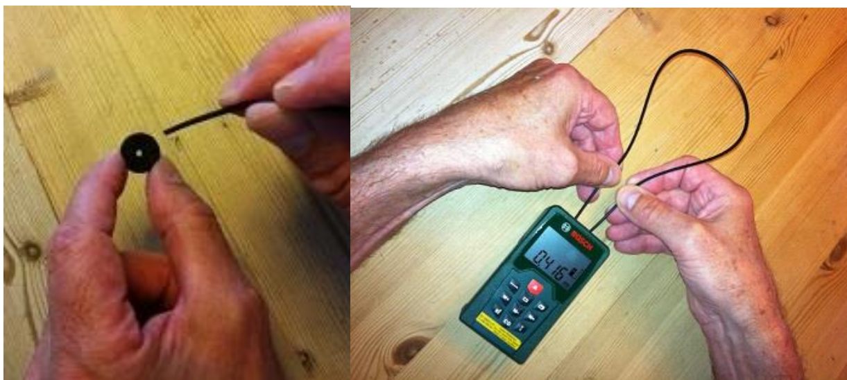
Obrázek 1.5 (a) Plstěná podložka a optický kabel. (b) Připevňování optického kabelu.
