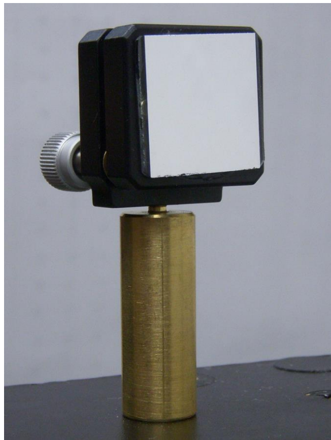
Zrcátko na pohyblivém podkladu se dvěma regulačními šrouby a nosným pilířkem (LABEL B).
